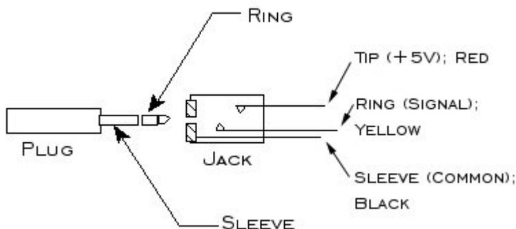
THE PLUG IS A STANDARD 2.5MM STEREO (TRS) PLUG. THE SUPPLIED JACK IS FULLY INSULATED FROM THE MOUNTING HOLE. OTHER 2.5MM JACKS MAY BE SUBSTITUTED - BUT MAKE SURE THAT THERE IS NO GROUND PATH BETWEEN THE COMMON TO ANY OF THE POWER INPUTS (C1:1,2 OR 6).
